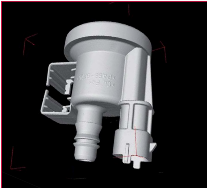
Industrielle Computertomografie: vollständiges Volumenmodell
